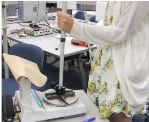
図4. アジャスターを回すトルク計測の様子
