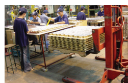
【良好事例1】仕掛品の品質チェック後、そのまま水平にリフターへスライドさせ、移動できる。
