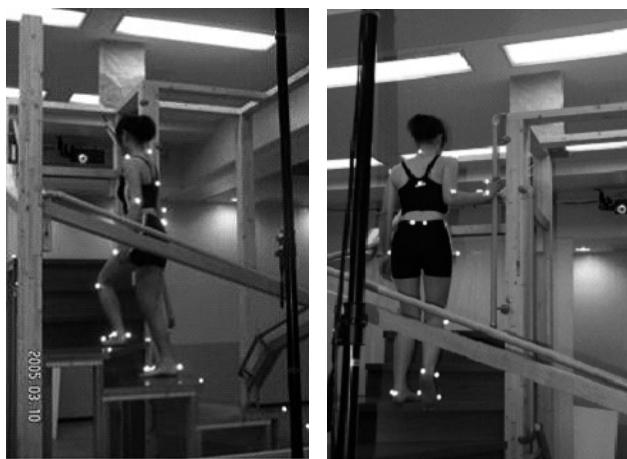
図17 階段を昇るときの内側新手すりの使用例
