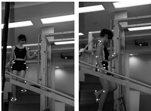
図16 階段を降りるときの内側新手すりの使用例
