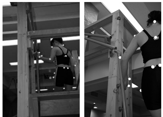
図15 階段を降りるときの内側従来手すりの使用例
