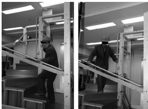
図18 外内両方の手すりを使用する高齢者の昇降例
