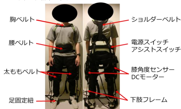
図1 下肢用パワーアシストスーツ
