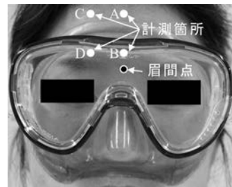
図1 スカート部を着色したダイビングマスクと脈波計測部位
