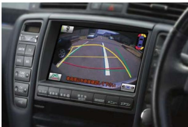
写真1：駐車支援システム「バックガイドモニタ」
