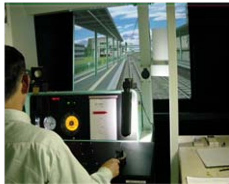
図 1：運転シミュレータでの実験風景
