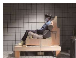
図2 クッションの沈み込み変位量の計測
