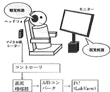
図1 快・不快感情状態の非接触推定システム
