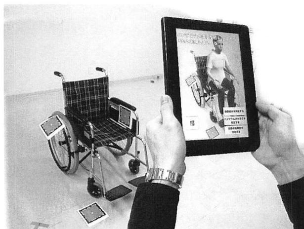
図3 ユーザの代役によるハンドリムの適合性評価
