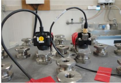
図 3. 3軸センサー取り付け比較検証
