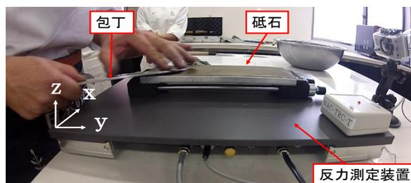
図1 反力測定装置
