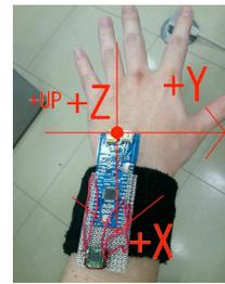
図3. 加速度センサの方向
