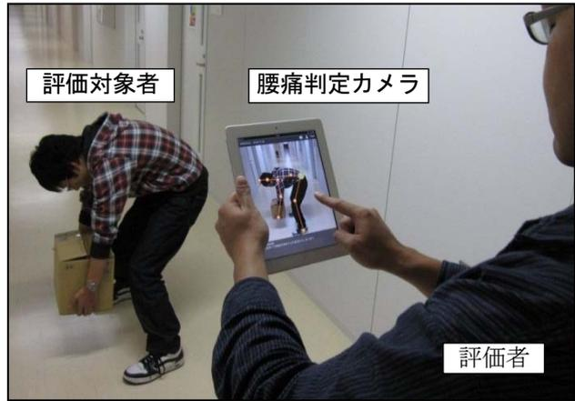
図 2 開発する腰痛判定カメラの使用イメージ
