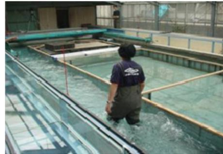
図5 通路模型 (幅 1m, 長さ 30m)
