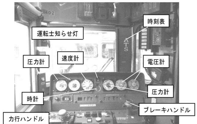
写真-2 115系近郊型電車 運転台
