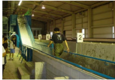
図4 階段模型 (幅 1m, 30 段)
