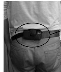
小型3軸加速度・気圧センサ
