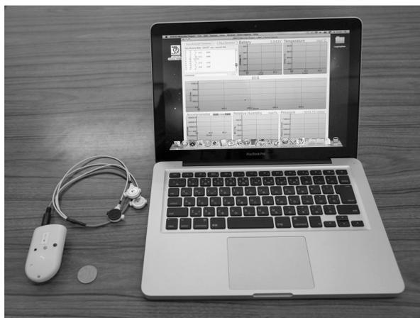
図2 小型生体計測装置
