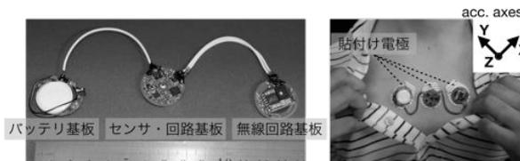
図 2 ECG モニタリングシステムと装着状態
