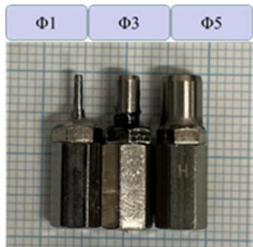
図3 先端直径が異なる刺激子の例。直径が小さくなることで接触時の感覚に痛み感が加わる<sup>2)</sup>
