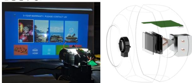
図 4 照射実験の様子と実装内部構造
