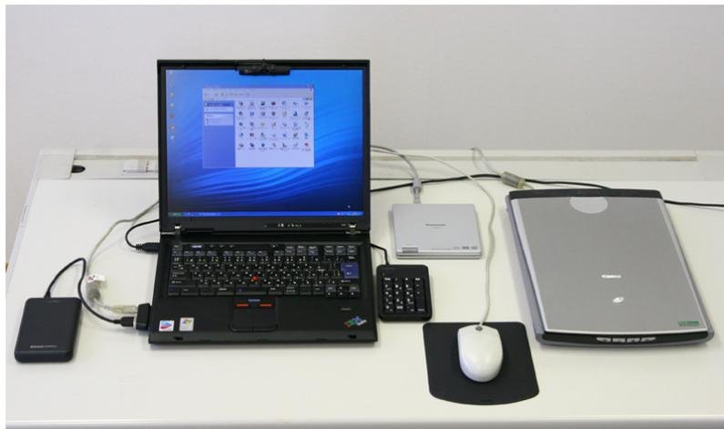
図 4.7.1 周辺機器の接続例（CD-ROM ドライブ、外付けハードディスク、マウス、外付けテンキーパッド、スキャナー）
